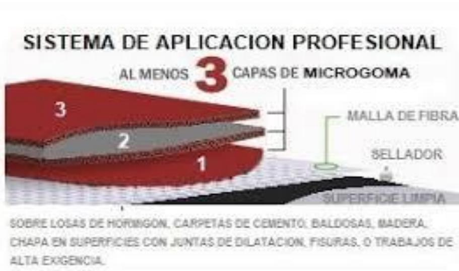
Para su aplicación, en primera medida aplicamos el sellador elastomérico (viene dentro del envase) diluyendolo de ser necesario con  $\frac{1}{2}$  litro de agua por cada litro de sellador. Luego colocamos la malla sobre la superficie y aplicamos la microgoma.
