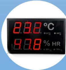
Para poder pintar, respetar siempre el rango de temperatura entre 10° C y 35°C, y que la HRA no supere los 80°.
